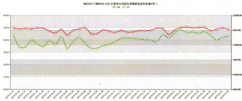
图 1-4 安装管控系统后系统单日运行功率 (ME)-COP (SC) 情况
